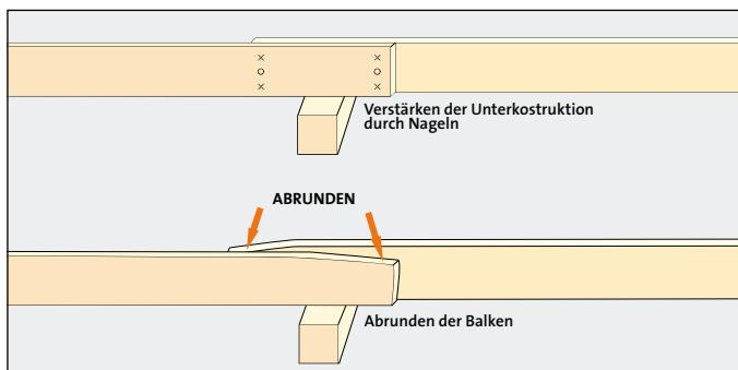
können die Balken auch miteinander vernagelt werden, um eine vollständig feste Verbindung der Balken zu erreichen. Bei 23 mm Parkett übernehmen wir keine Garantie, wenn es auf einer Lagerholzkonstruktion mit Fußbodenheizung verlegt wird.
